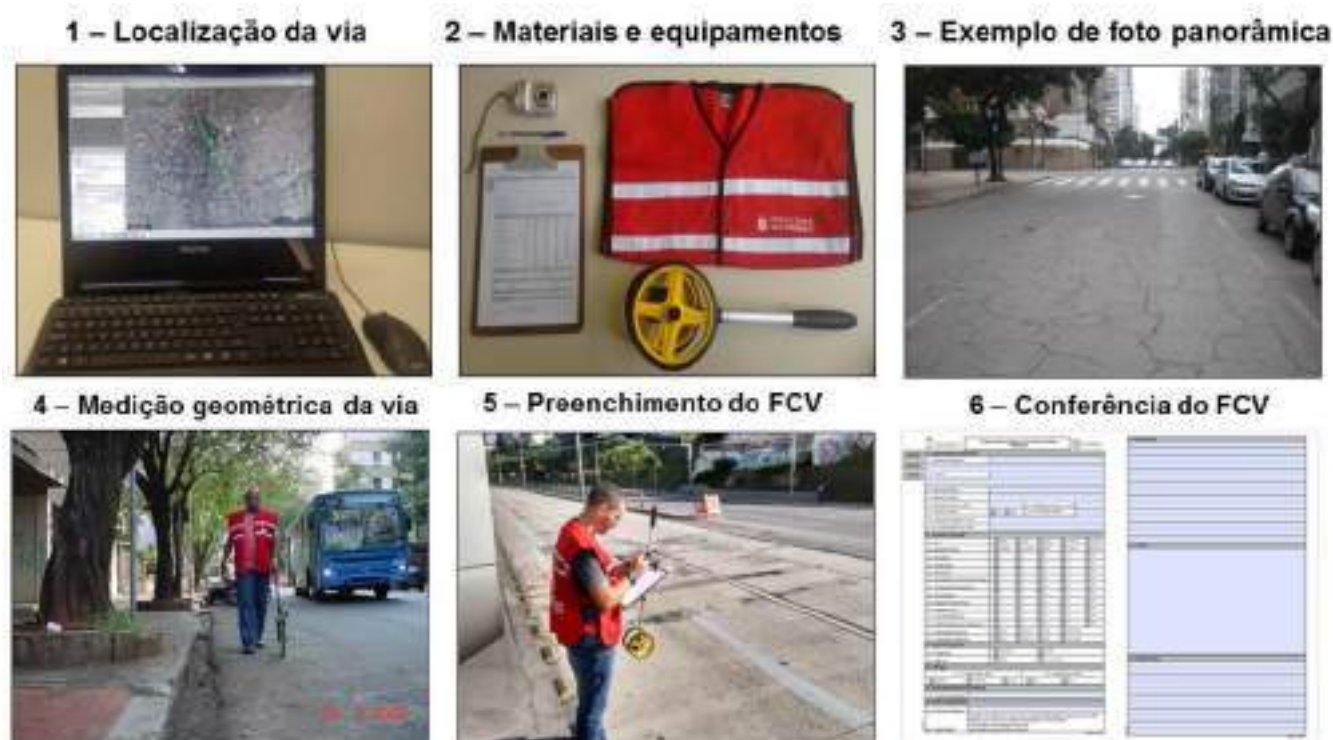
Figura 32 – Sequência de etapas para realização de vistoria técnica e elaboração de orçamento
