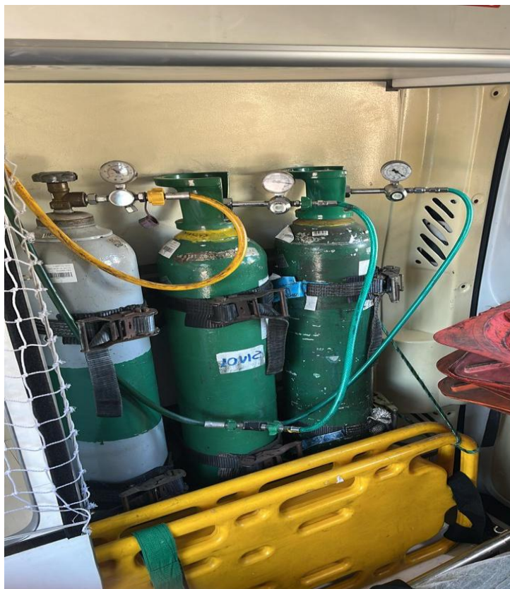
Foto 1: Disposição de 2 cilindros de oxigênio e 1 de Ar medicinal para ambulâncias do tipo B
