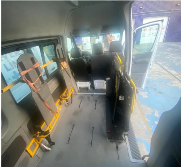
Foto 5: Disposição de 2 cilindros de oxigênio para ambulâncias do tipo A com acessibilidade
