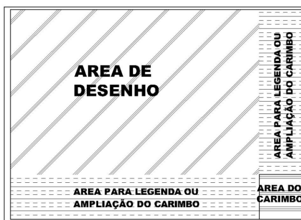
Figura – Esquema de prancha e indicação de carimbo e legenda (fonte: NBR 13142- ABNT).
