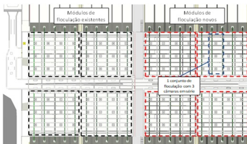
Figura 2: Ampliação do Módulo de Floculação – Fonte Arcadis
