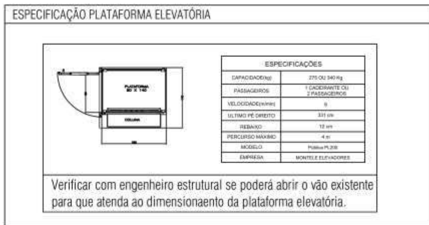
Figura 10 - Tabela de especificação da plataforma elevatória
