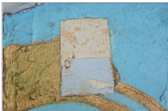
Foto: 0367 Detalhe do procedimento de prospecção, com abertura de pequena janela, para análise da camada pictórica.
