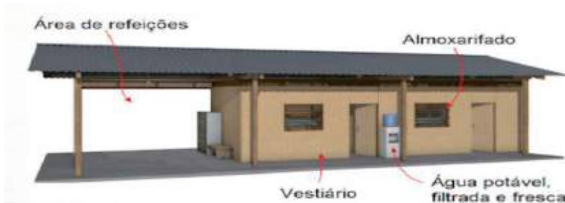
Figura 09 – REF | Canteiro Inteligente – Área de vivência
