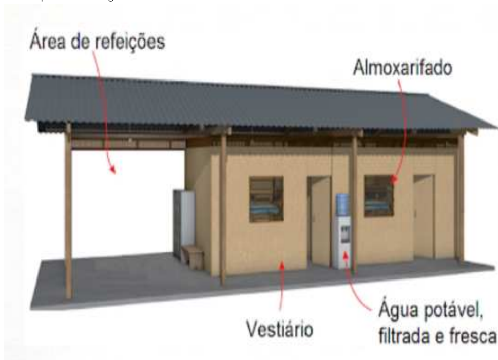
Figura 17 – REF | Canteiro Inteligente – Área de vivência
