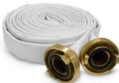
Figura 10 – Imagem Ilustrativa da mangueira de incêndio, tipo 2, de 2 1/2", comprimento = 15 m, tecido em fio de poliéster e tubo interno em borracha sintética, com uniões engate rápido
