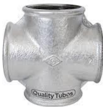
Figura 6 – Imagem Ilustrativa da Cruzeta de aço galvanizado com costura, classe média, DN 65 (2 1/2"), conexão rosqueada
