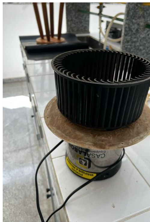
Motor com hélice (voluta) fornecido pelo cliente.
