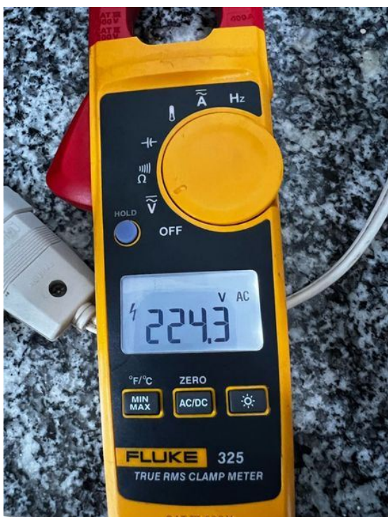
Tensão elétrica de alimentação.
