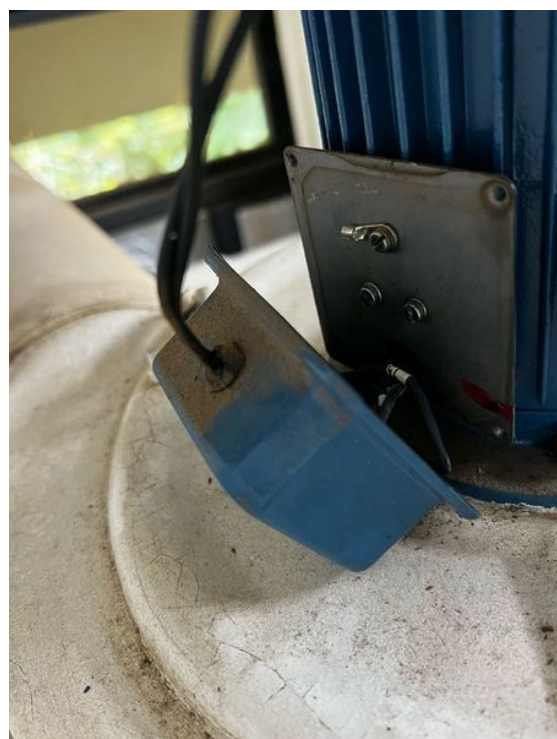
Tampa do motor estava solta.
