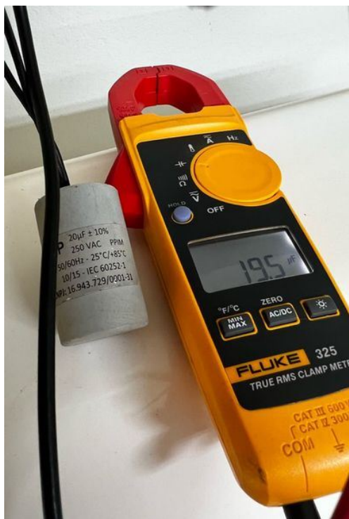
Capacitância do capacitor de partida do motor.
