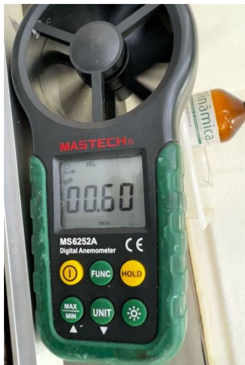
Vazão de ar (lado esquerdo).
