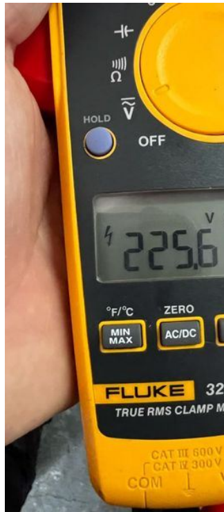
Tensão elétrica de alimentação.
