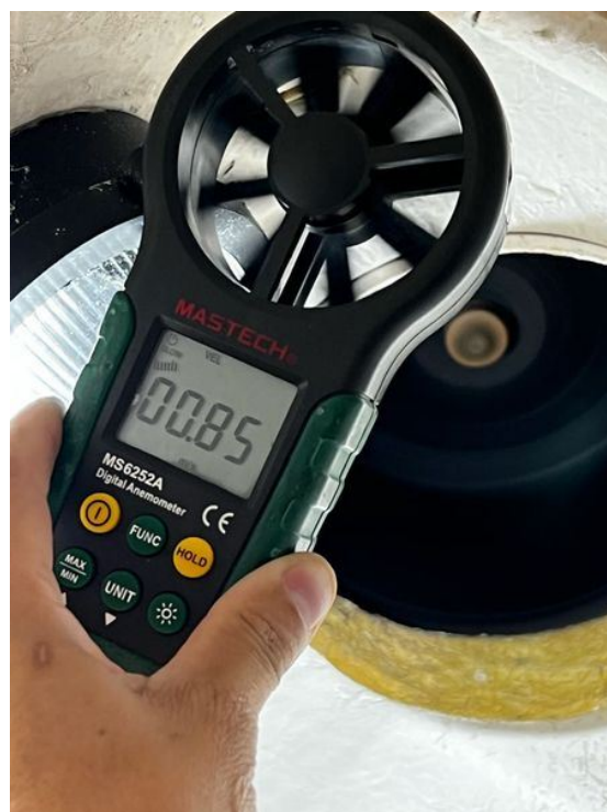
Vazão de ar (superior).
