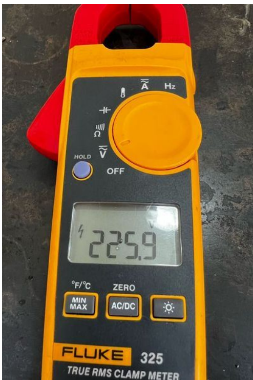
Tensão elétrica de alimentação.
