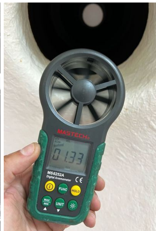
Vazão de ar (superior).
