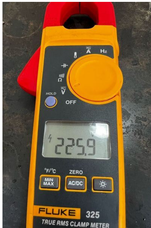
Tensão elétrica de alimentação.
