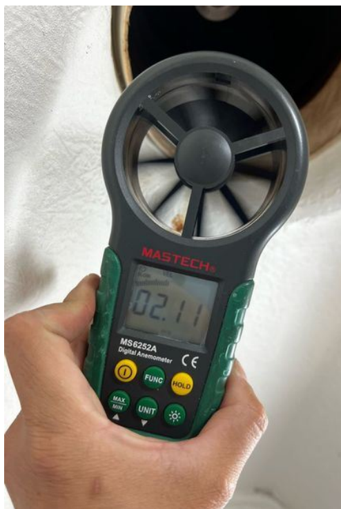
Vazão de ar (superior).
