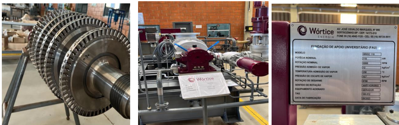
Figura 5 – Conjunto da turbina a vapor finalizado – previsão de entrega em dezembro de 2024 após realiza as melhorias no galpão do Campus Glória UFU.
