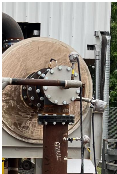
Figura 2 – Instrumentação do queimador: a) sensores montados no queimador e b) painel elétrico
