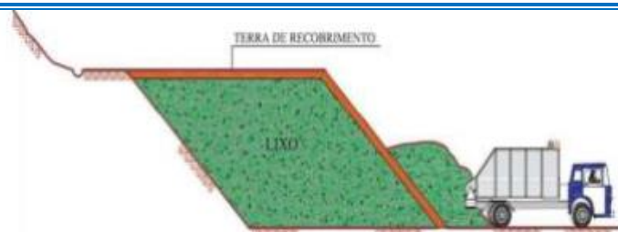
Figura 3 - Descarregamento de resíduos no pé do talude. Fonte: AMBIENGE – Engenharia Sanitária e Ambiental Ltda.
