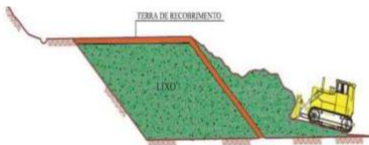
Figura 4 - Espalhamento e compactação dos resíduos. Fonte: AMBIENGE – Engenharia Sanitária e Ambiental Ltda.
