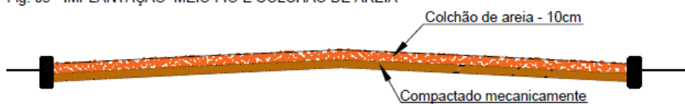
Fig. 03 - IMPLANTAÇÃO MEIO FIO E COLCHÃO DE AREIA
