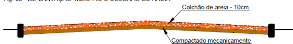
Fig. 03 - IMPLANTAÇÃO MEIO FIO E COLCHÃO DE AREIA
