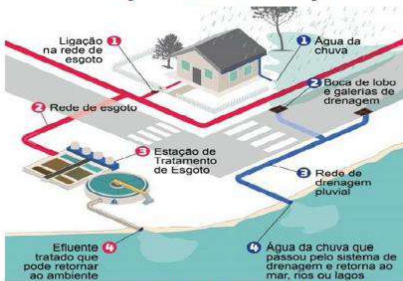
Figura 7 - Elementos da rede de esgoto.
