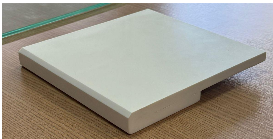
Figura 7 - Item e) Tampo em superfície sólida (SSM) – verificação de acabamento e integridade do material – Resultado: Conforme
