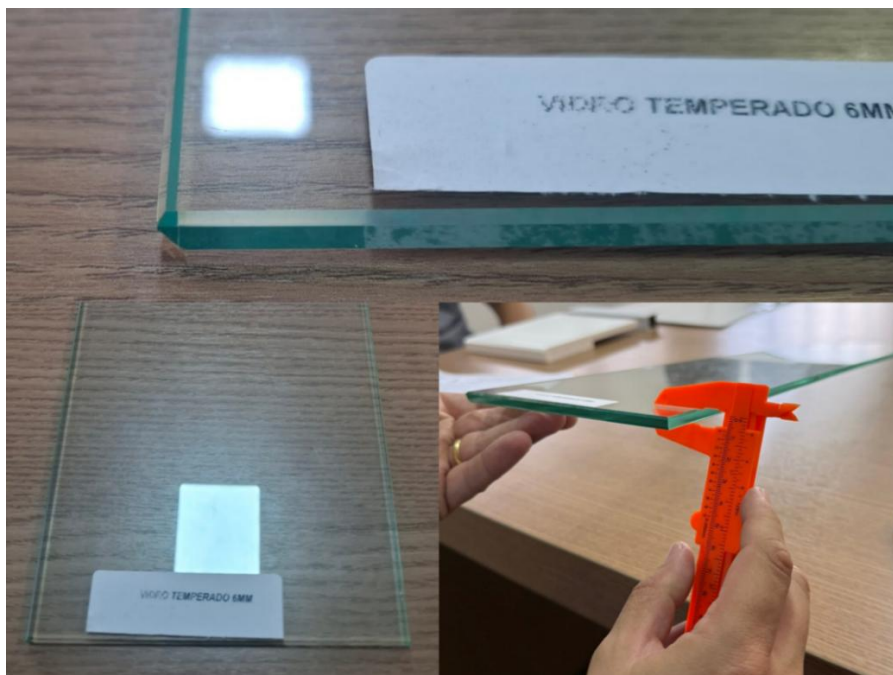
Figura 10 - Item h) Vidro temperado – verificação de espessura e acabamento das bordas – Resultado: Conforme
