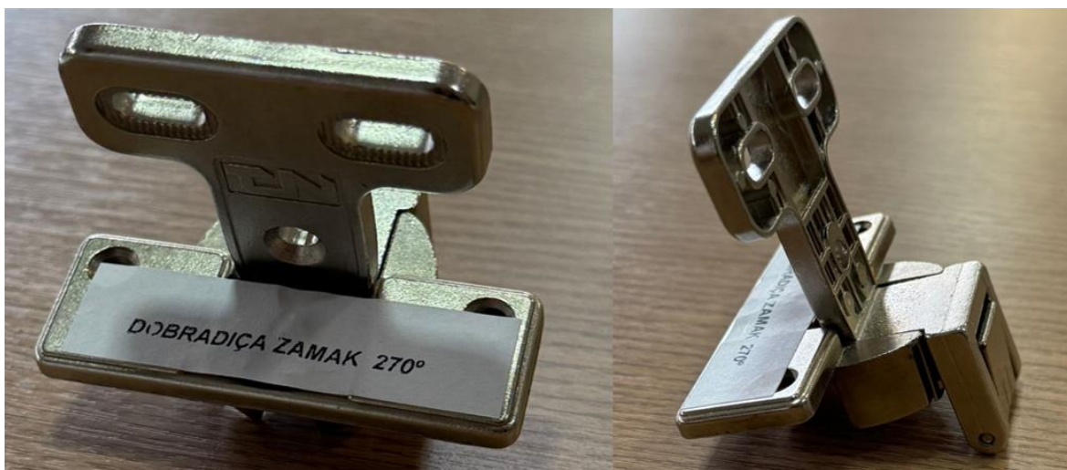
Figura 4 - Item c) Dobradiças – verificação de funcionamento e sistema de regulagem – Resultado: Conforme
