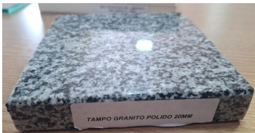
Figura 6 - Item e) Tampo em granito – verificação de espessura e acabamento de bordas – Resultado: Conforme
