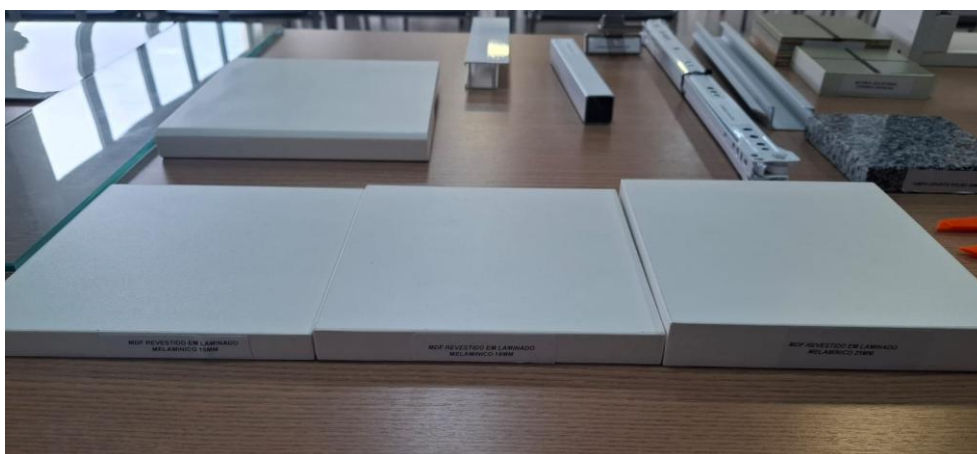
Figura 2 - Item a) MDF revestido em laminado melamínico – verificação de espessuras e acabamento de bordas – Resultado: Conforme
