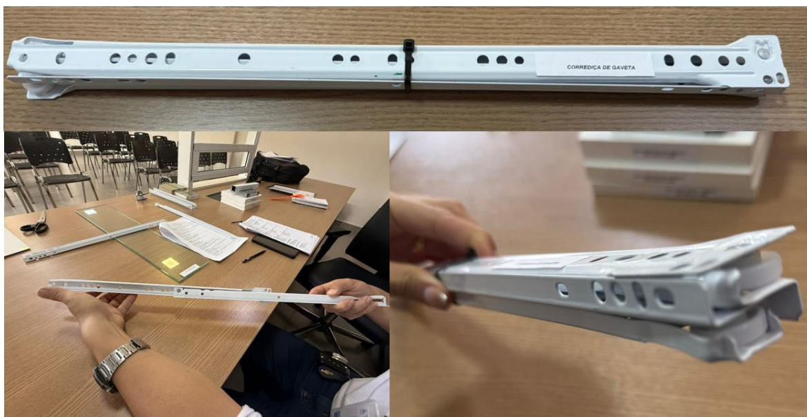
Figura 3 - Item b) Corrediças de gaveta – verificação de funcionamento e robustez construtiva – Resultado: Conforme
