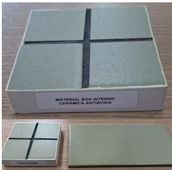
Figura 11 - Item i) Material do box interno da capela – verificação de revestimento cerâmico antiácido – Resultado: Conforme
