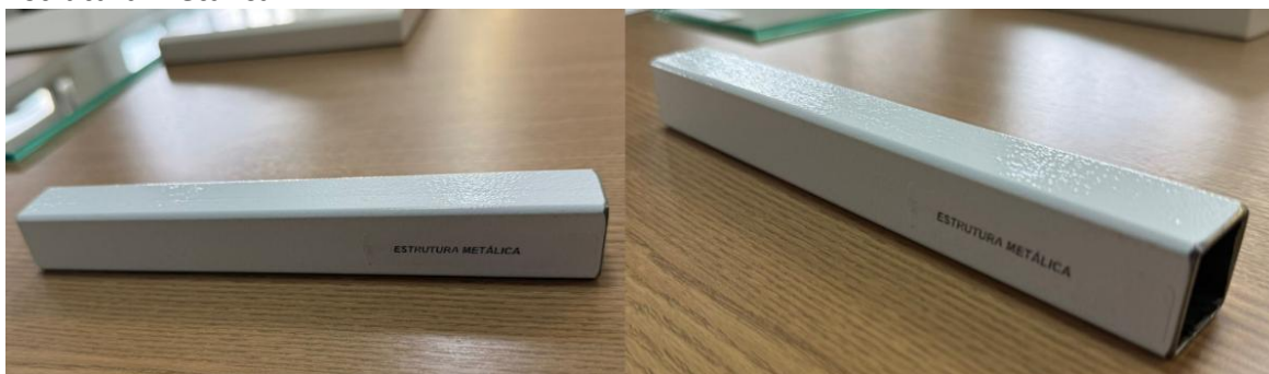
Figura 9 - Item g) Estrutura metálica – verificação de pintura epóxi e aderência – Resultado: Conforme
