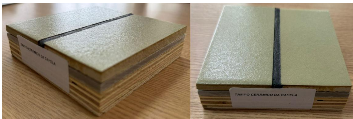
Figura 12 - Item j) Tampo cerâmico da capela – verificação de acabamento e proteção térmica – Resultado: Conforme
