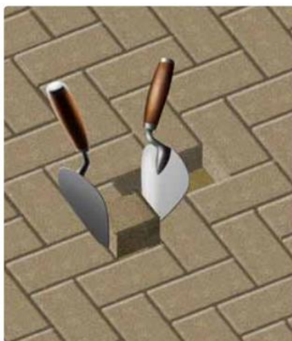
Retirada de blocos danificados com colher de pedreiro
