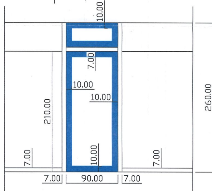
D3 PORTAS DETALHE VISTA FRONTAL
