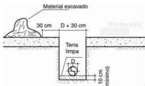
Figura 2 - Escavação de vala
