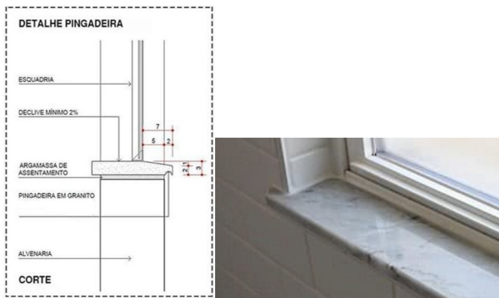
Detalhe de instalação de pingadeira. Imagem ilustrativa.
