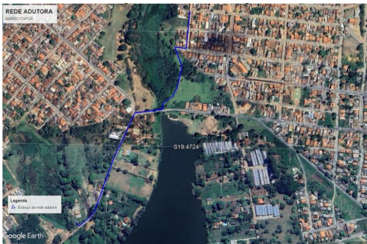
IMAGEM 1 - escopo do traçado da adutora de recalque:
