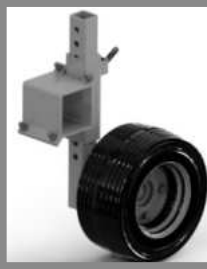
Roda de apoio Auxilia no acompanhamento do terreno, possibilitando a regulagem de altura, diminuindo o impacto no engate no terceiro ponto do trator.)
