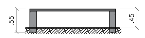
33 VISTA FRONTAL BANCO EM CONCRETO ESCALA 1:50
