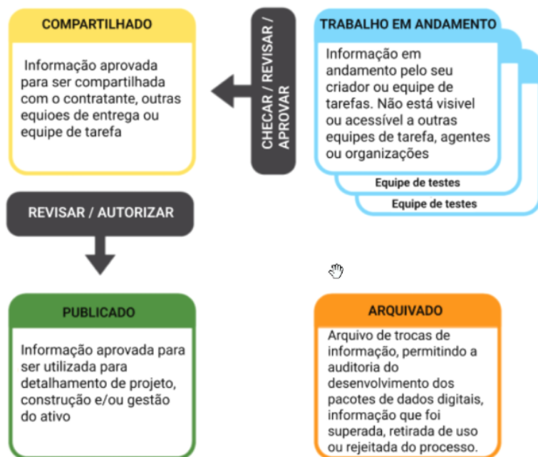
Figura 2 – Descrição dos estados dos contêineres de informação
