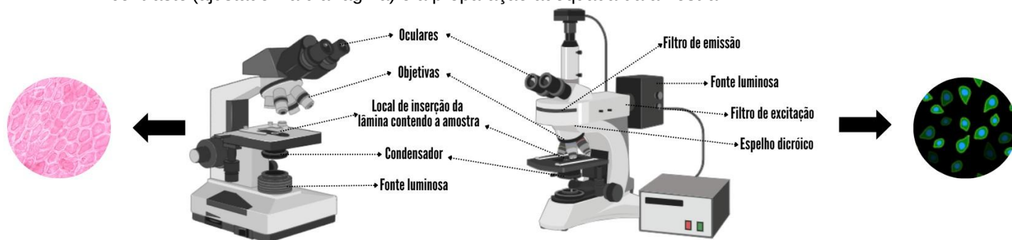
Figura 1. Ilustração demonstrando o funcionamento dos microscópios ópticos e de fluorescência. Fonte: elaboração própria.
