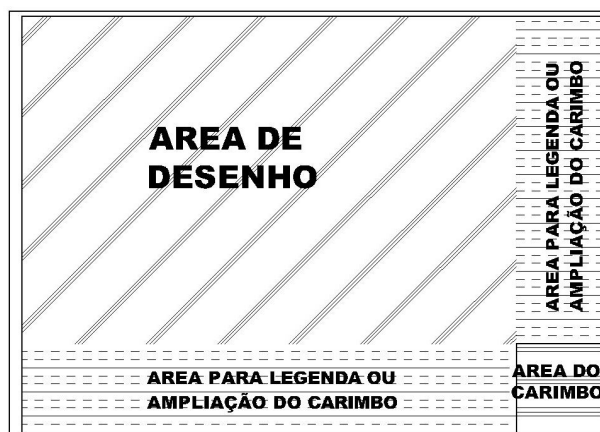
Figura – Esquema de prancha e indicação de carimbo e legenda (fonte: NBR 13142- ABNT).
