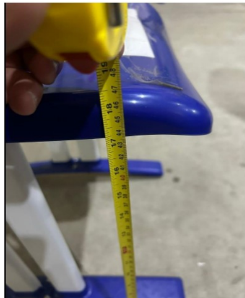
Figuras 4 e 5 - Imagem apresentada pela empresa Mobie, com aparente distorção da medida (470 mm)
