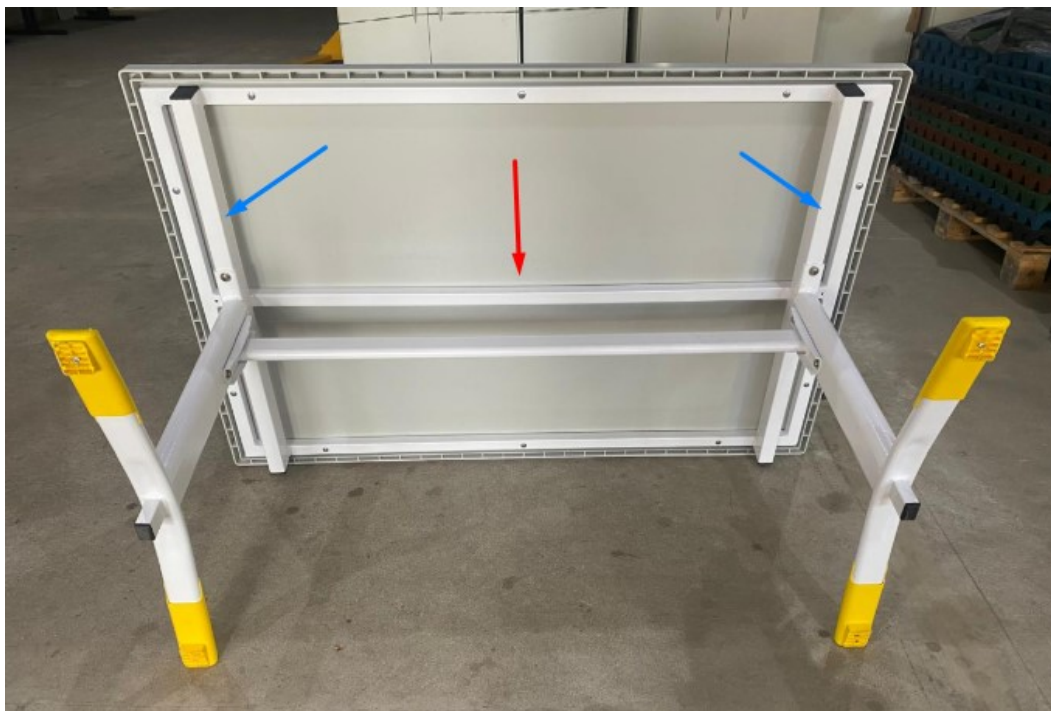
Figura 1 - Reforços implementados pela Empresa Solução, em substituição ao tubo na diagonal
