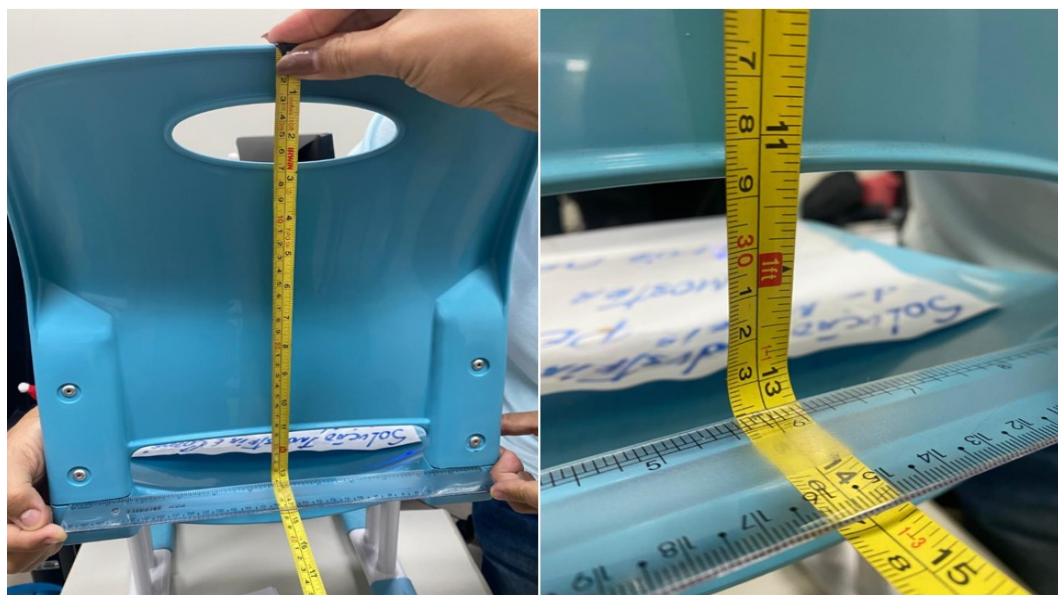
Figuras 1 e 2 - Demonstração de medição, demarcada pela régua (fim da estrutura do assento)
