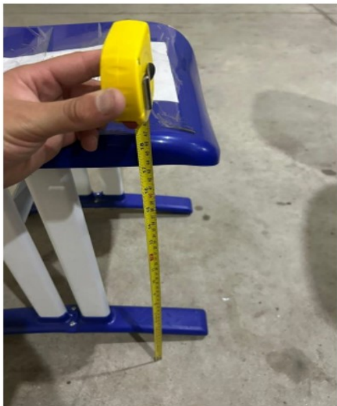
Figuras 4 e 5 - Imagem apresentada pela empresa Mobie, com aparente distorção da medida (470 mm)
