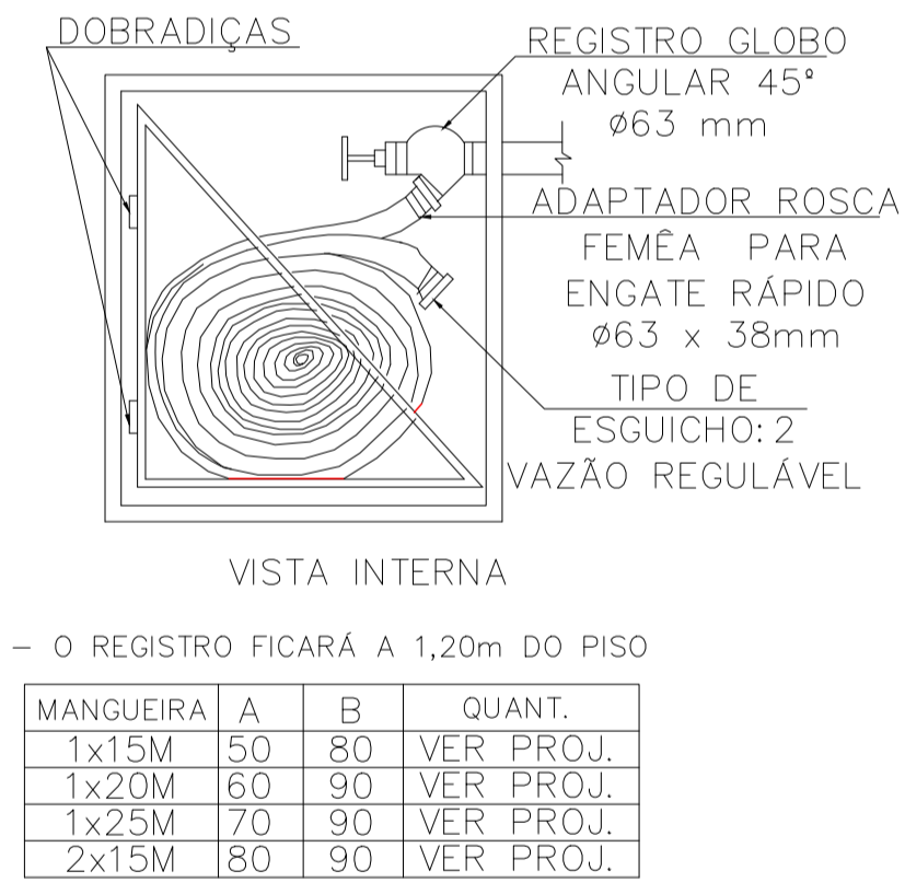
DET. HIDRANTE DE PAREDE DE SOBREPOR (HP) ESCALA 1/25
