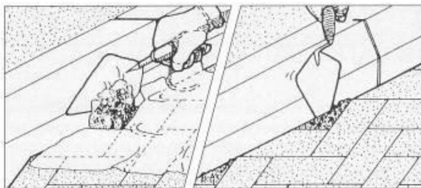
Figura 6.16 – Preenchimento de Espaços com Argamassa
