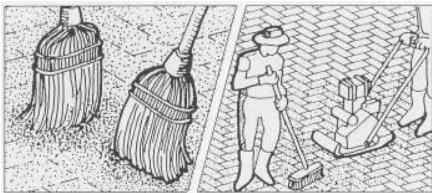
Figura 6.25 – Aplicação da Areia para o Rejunte dos Blocos
