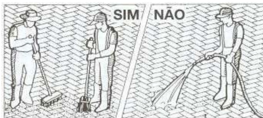
Figura 6.33 – Limpeza Correta dos Blocos
