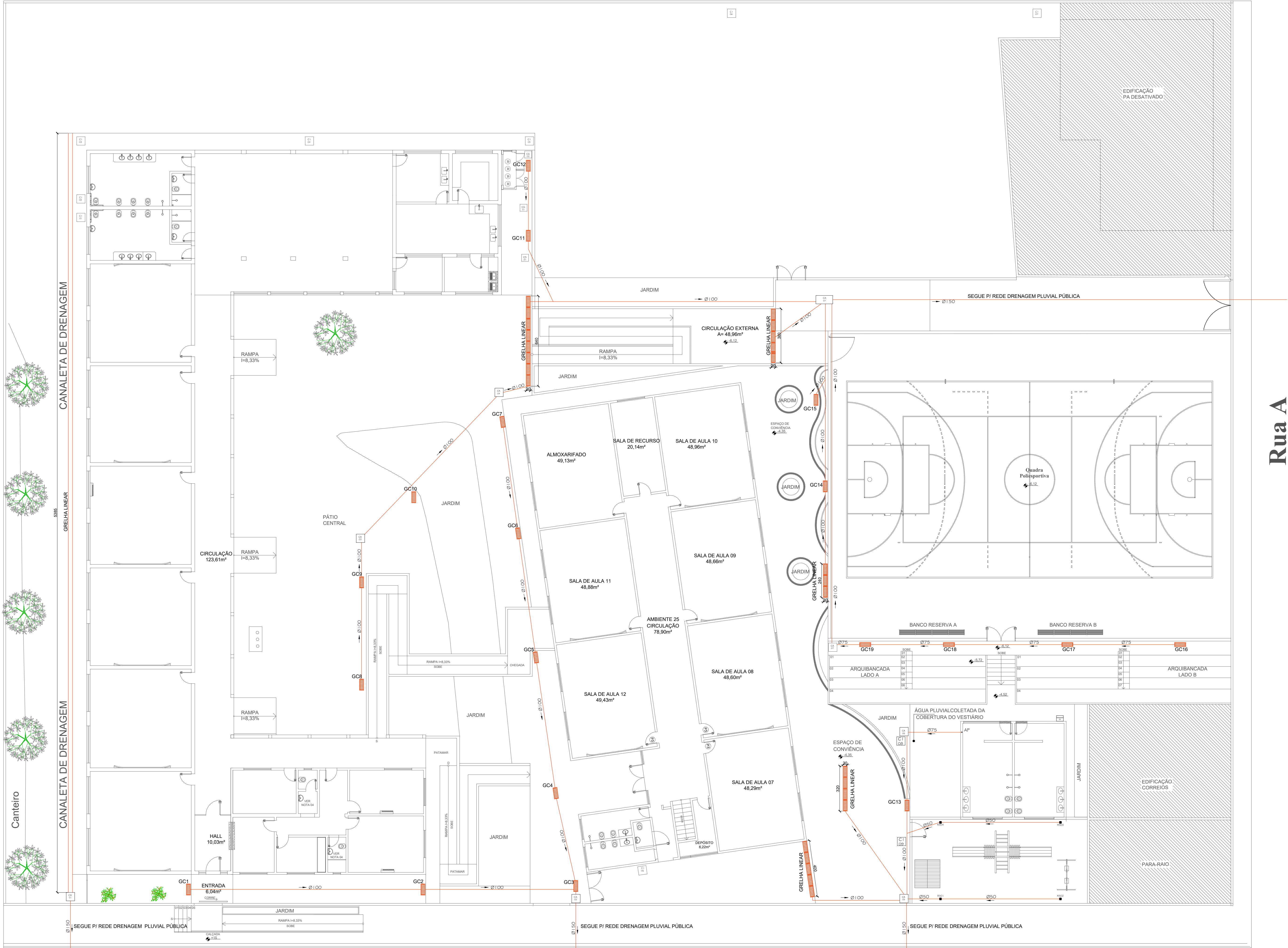
PLANTA DE DRENAGEM PLUVIAL EBC - 1:125
