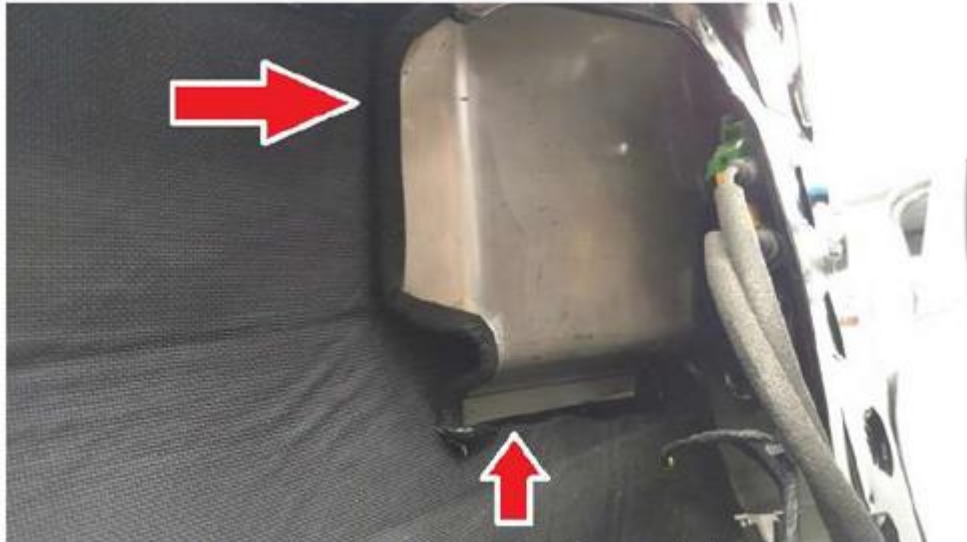
Figura 11 - Detalhe do reforço em chapa de aço inox na região da maçaneta
