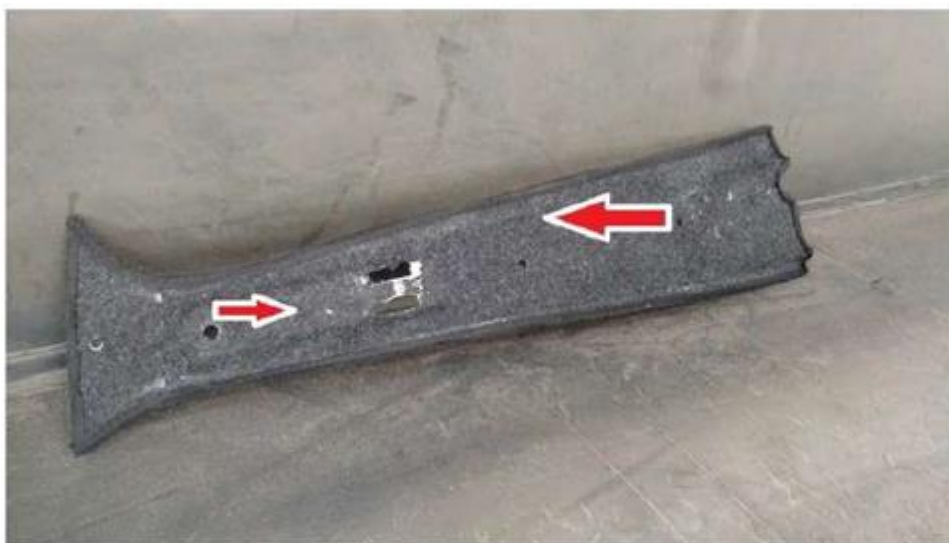
Figura 4 - Detalhe do carpete aplicado na face oposta da chapa de aço
