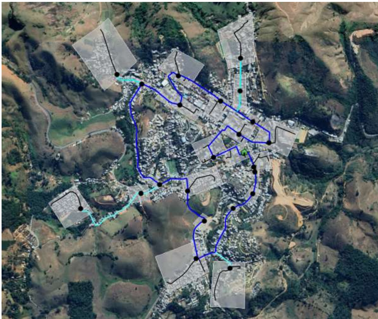
Figura 5 - Proposta de infraestrutura de fibra óptica
