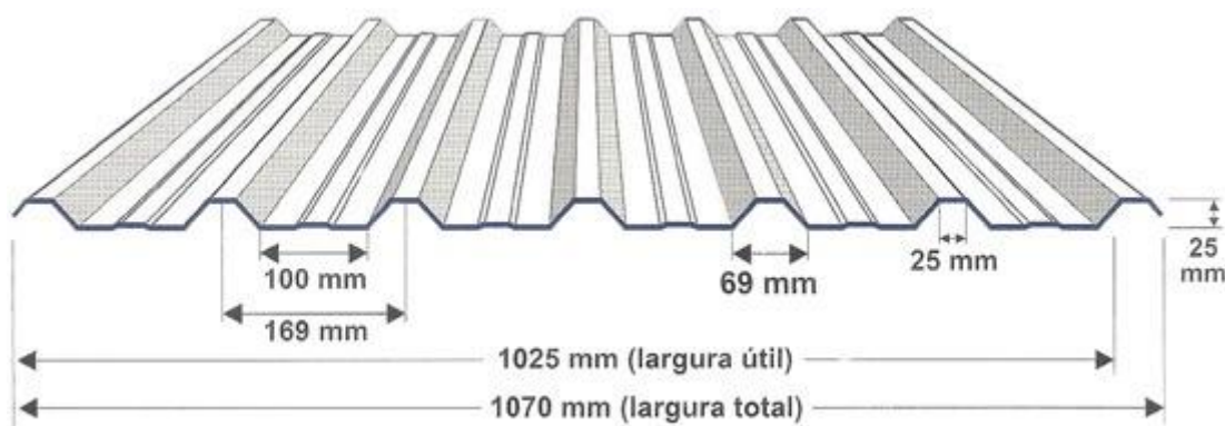
Figura 59- lustração de telha metálica trapezoidal simples.
