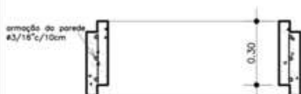
DETALHE - ANEL h=30cm ESC.: 1/20
