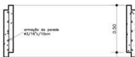
DETALHE - ANEL h=50cm ESC.: 1/20
