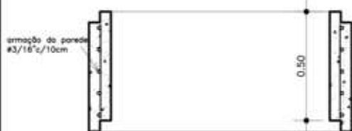
DETALHE - ANEL h=50cm ESC.: 1/20
