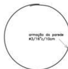
DETALHE - ARMAÇÃO da PAREDE ESC.: 1/20
