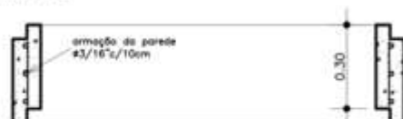
DETALHE - ANEL h=30cm ESC.: 1/20
