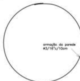
DETALHE - ARMAÇÃO da PAREDE ESC.: 1/20
