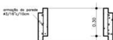
DETALHE - ANEL h=30cm ESC.: 1/20
