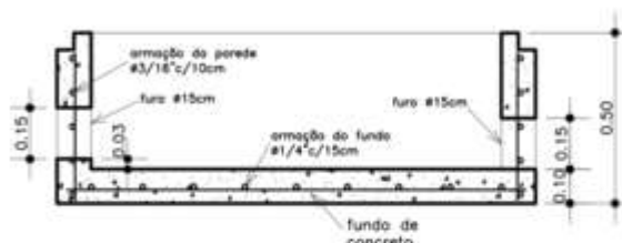
DETALHE - ANEL C/ FUNDO ESC.: 1/20
