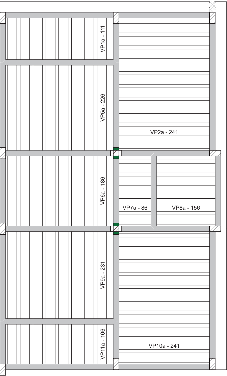
PLANTA DE VIGOTAS PRÉ-MOLDADAS 1º PAVIMENTO
