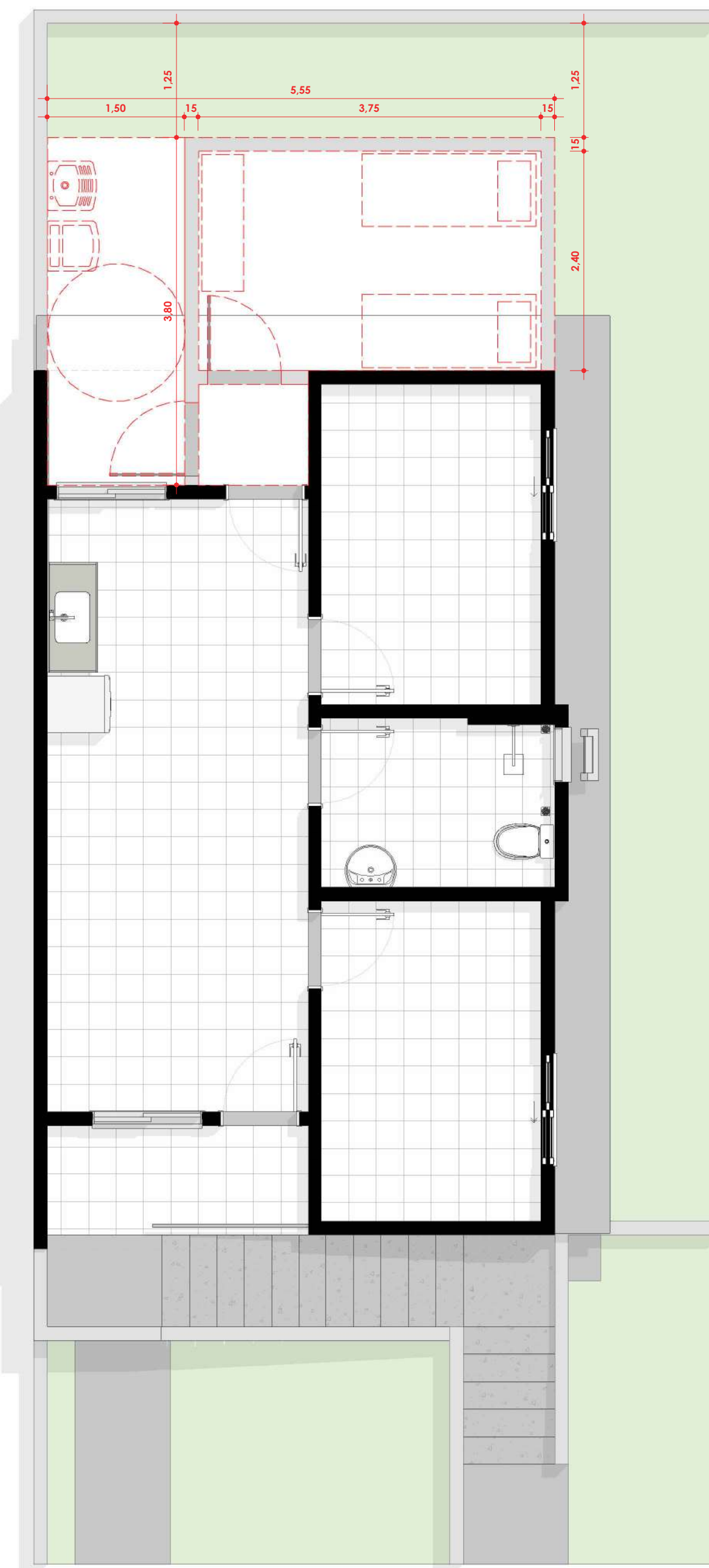
4 1º Pavimento - Ampliação 1 : 50
