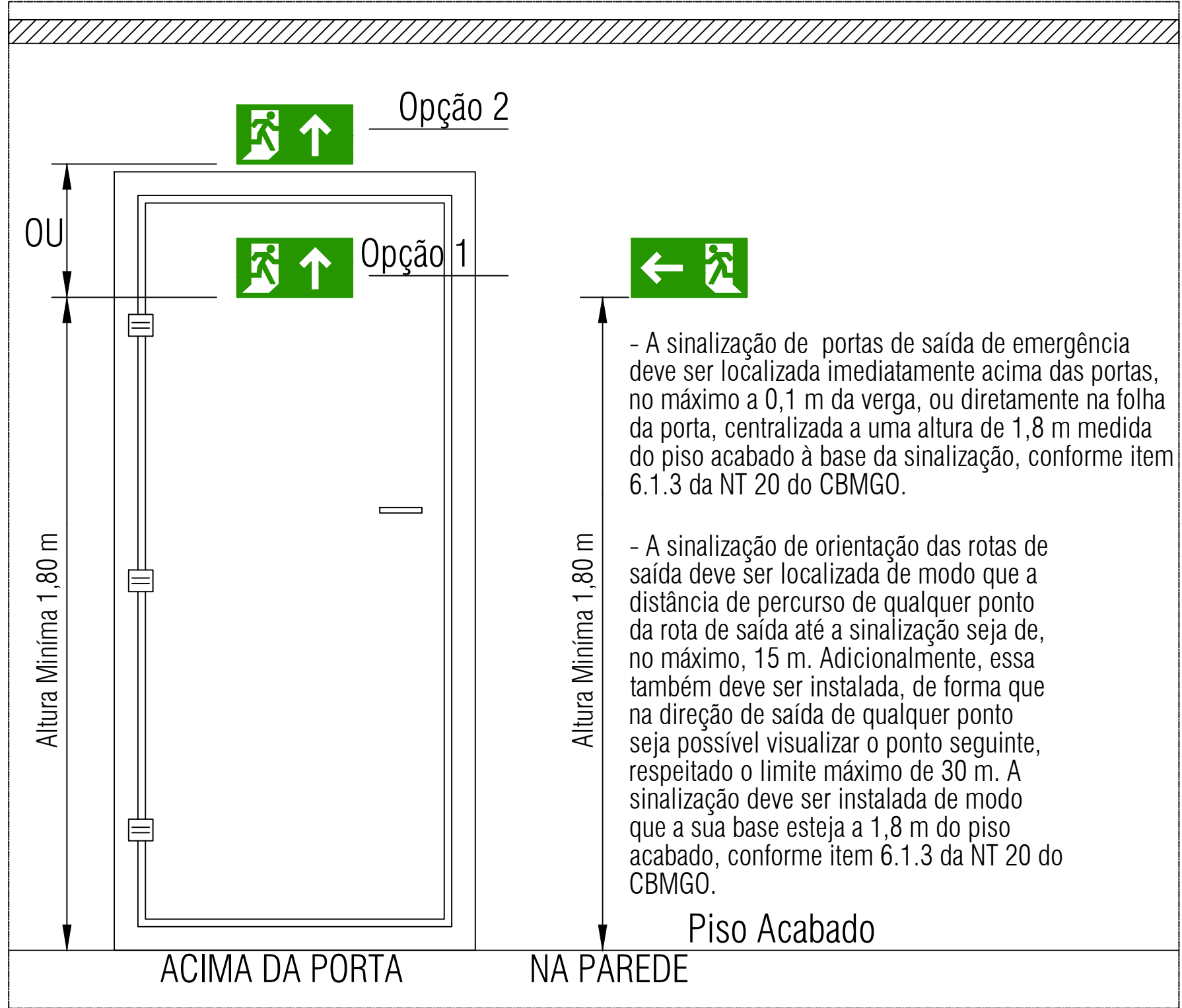
Detalhe da sinalização das saídas de emergência
