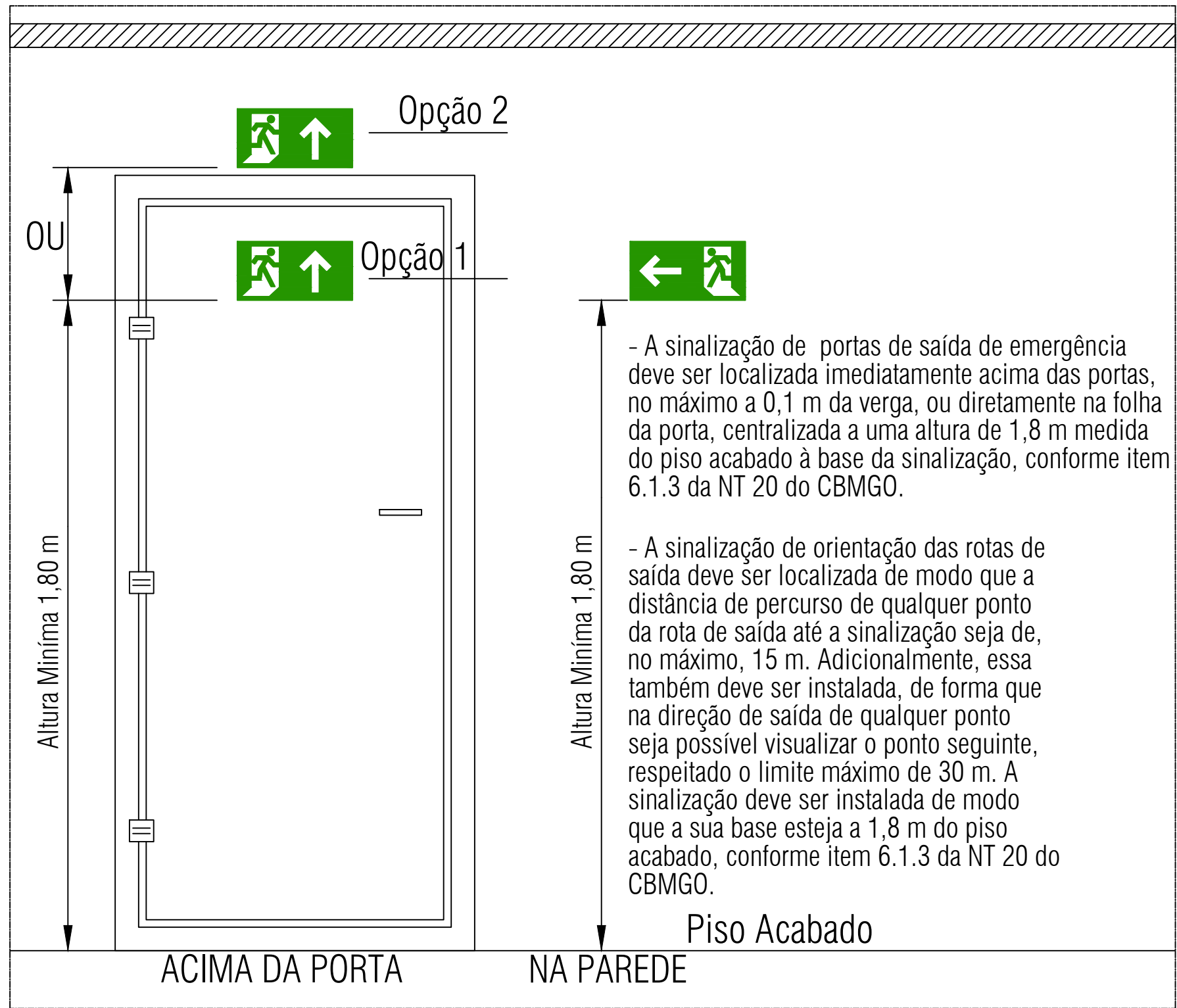
Detalhe da sinalização das saídas de emergência Sem escala
