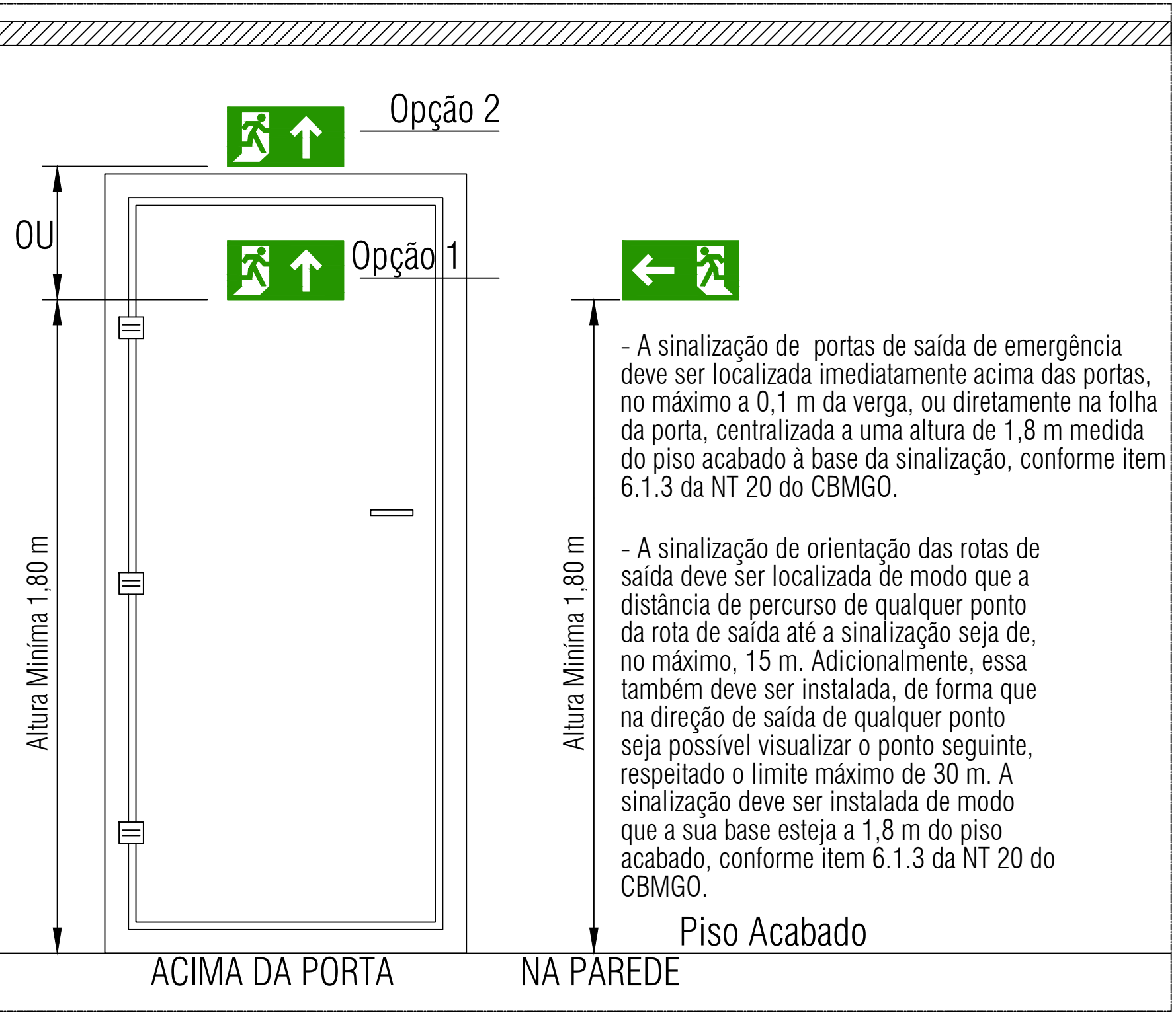
Detalhe da sinalização das saídas de emergência
