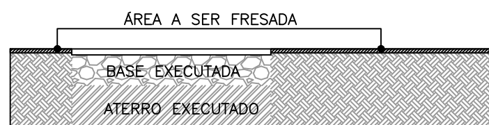
FRESAGEM - SEÇÃO A-A ESCALA 1:75
