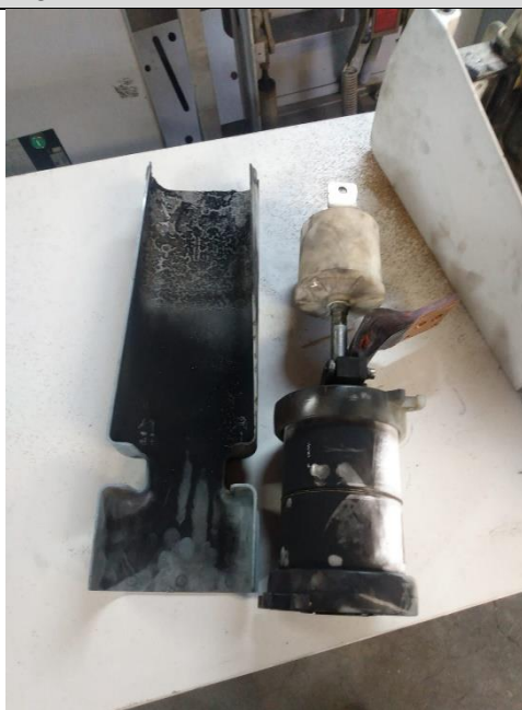
FOTO Nº 10: DETALHES DO POLO DA FASE "R" QUE EXPLODIU
