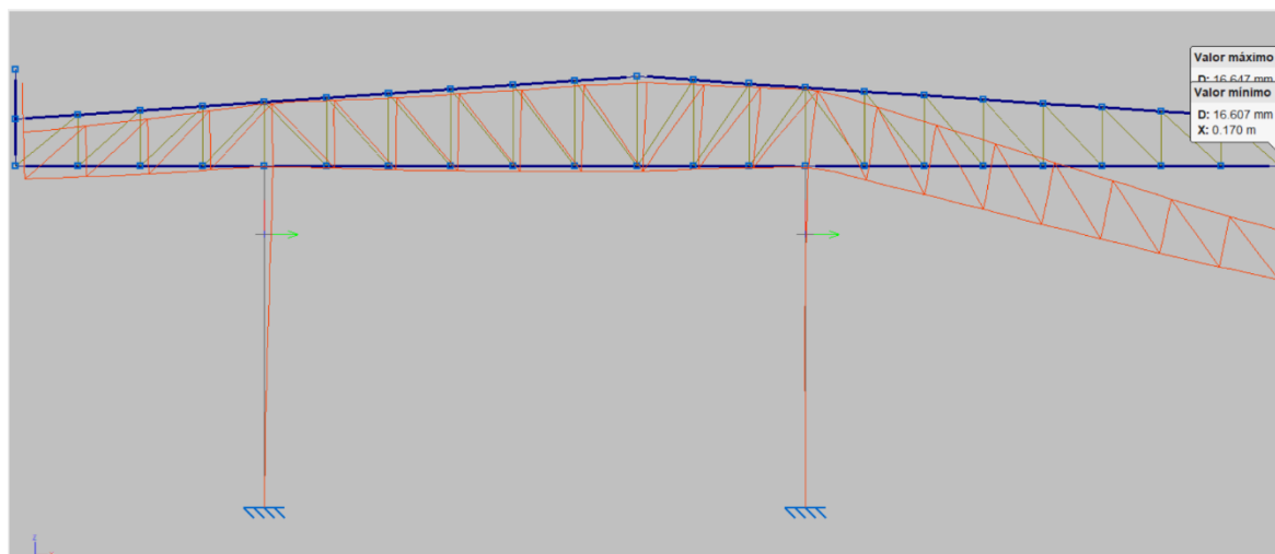
Figura 28: Configuração deformada do conjunto central de treliças.
