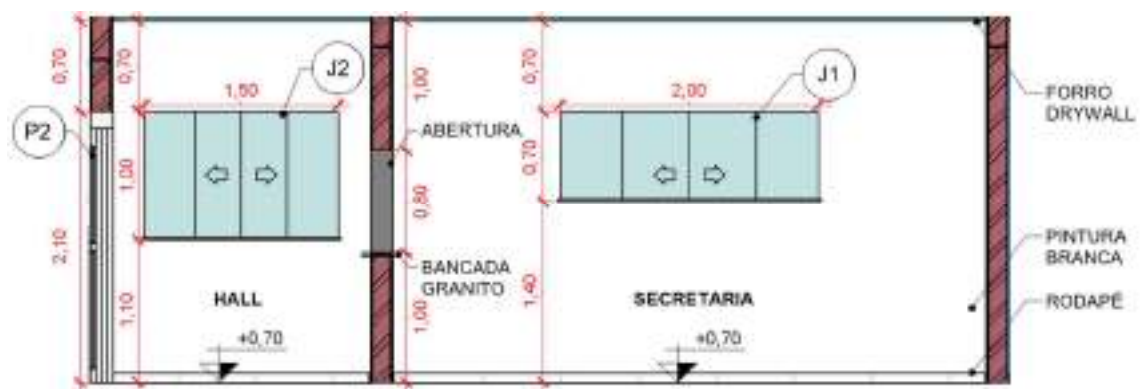
Figura 35 – Vista esquadrias Hall e Secretaria
