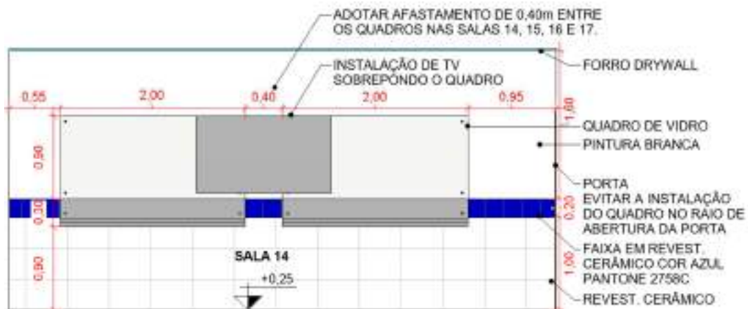
Figura 39 – Instalação de Quadro com afastamento de 0,40m
