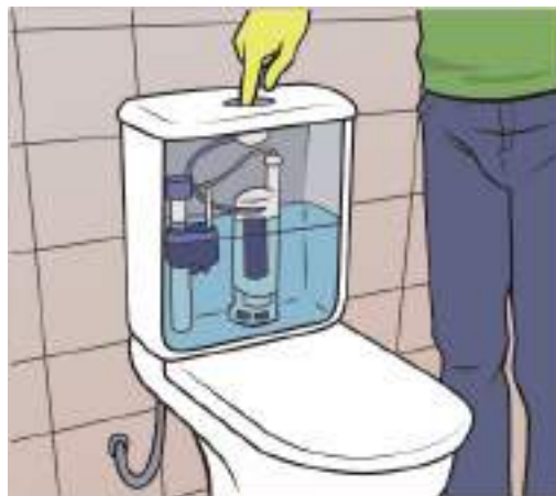
Figura 40 – Visualização de mecanismo de Caixa Acoplada
