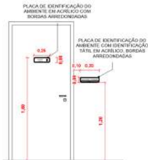
Figura 51 - Instalação de Identificação de Ambientes
