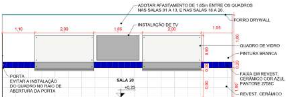
Figura 38 – Instalação de Quadro com afastamento de 1,60m
