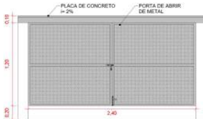
Figura 33 – Porta metálica de abrir – Abrigo de Resíduos
