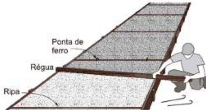
Figura 55 - Execução de Calçamento de Concreto
