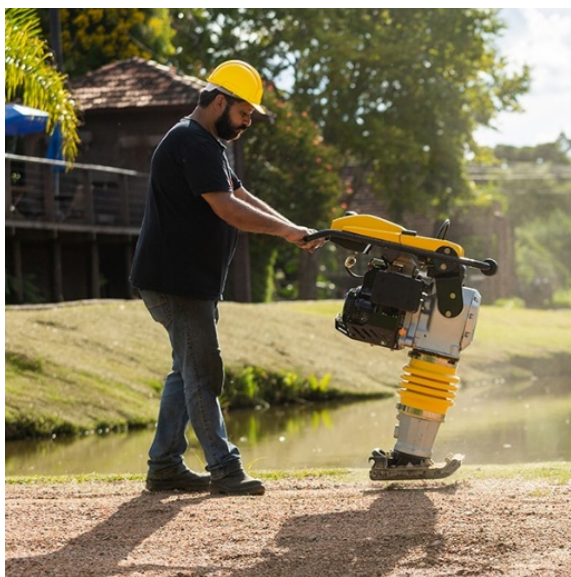
Figura 35 - Uso de Compactador de Solos de Percussão (soquete)
