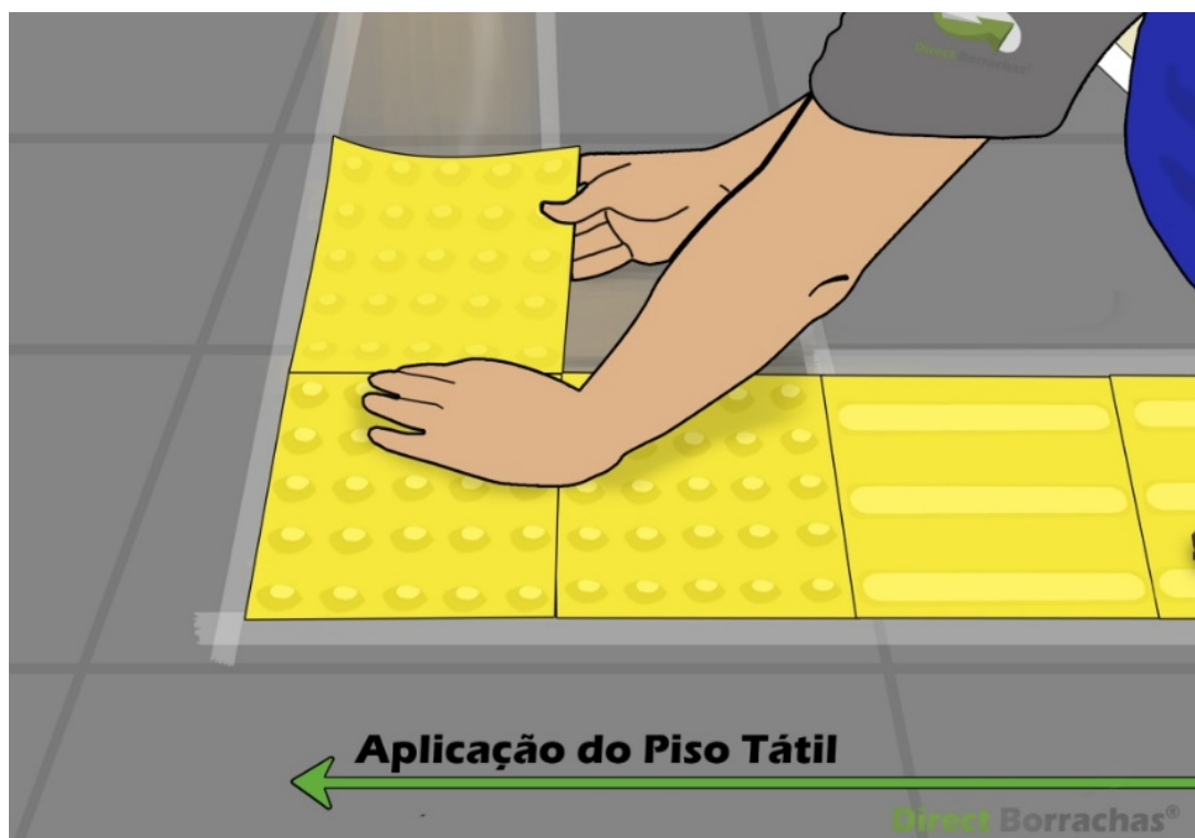
Figura 30 - Aplicação de Piso Tátil Emborrachado
