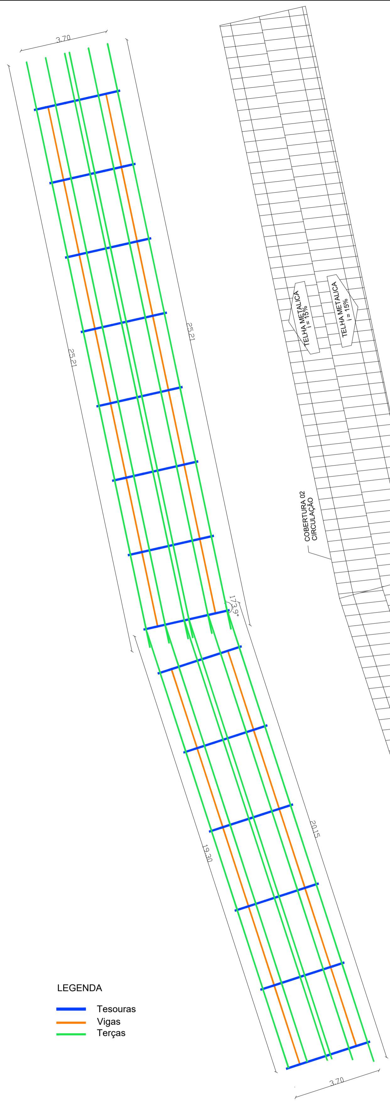
ESTRUTURA METÁLICA PLANTA DE LOCAÇÃO ESCALA: 1/100
