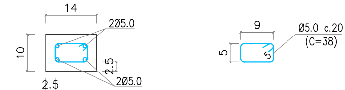
DETALHE DAS FERRAGENS CINTAS SUPERIORES (14x10) ESCALA: 1/10 MEDIDAS EM CM.
