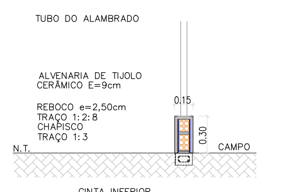
DETALHE DAS FUNDAÇÕES DA MURETA ESCALA: 1/50
