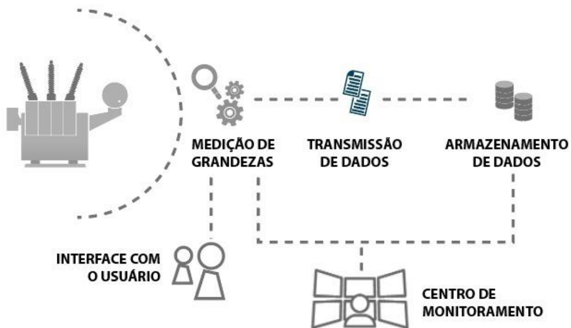
Figura 2 - Topologia típica do sistema de monitoramento
